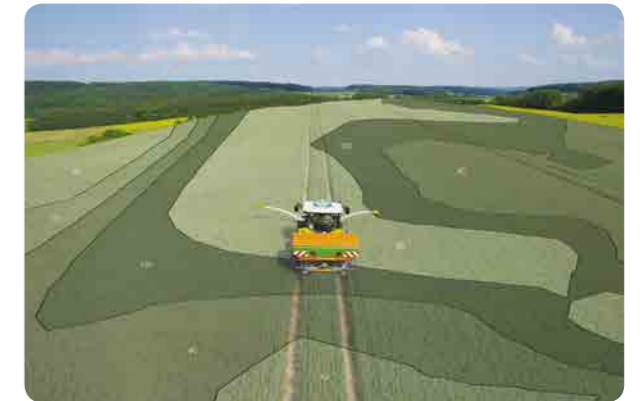
Przejazd roboczy Systemu CLAAS CROP SENSOR ISARIA wraz z symulacją stref potencjalnego plonowania.
