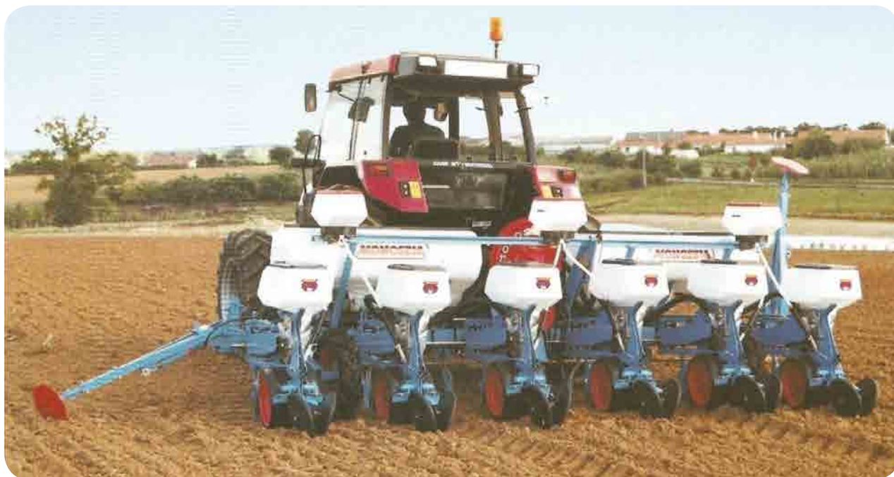
Rys.1 Siewnik Monosem przystosowany do wysiewu mikro-granulatu
