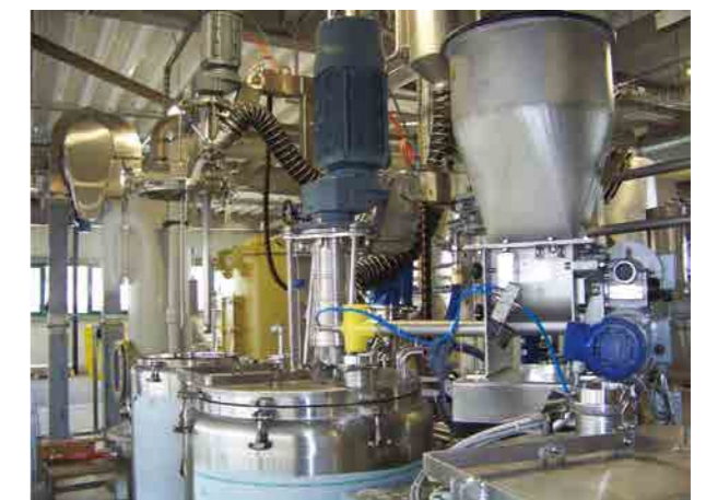
Instalacja granulacji nawozów – węzeł przygotowania pulpy nawozowych
