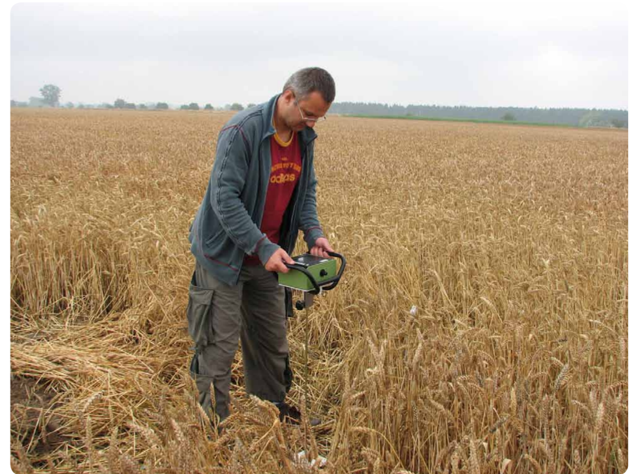
Fot. 2. Pomiar zwięzłości gleby przy użyciu penetrometra glebowego.
