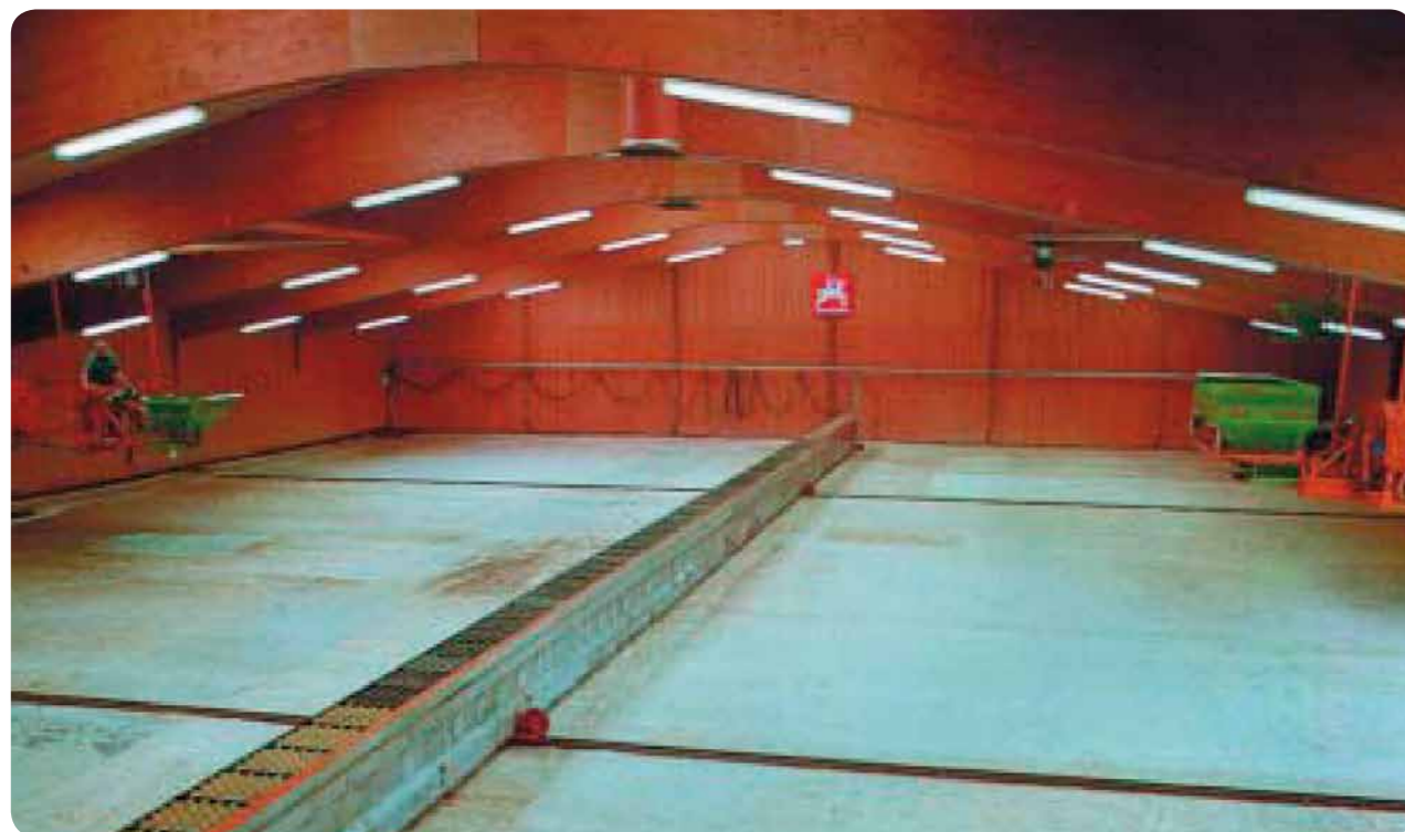
Specjalistyczna hala do testowania rozsiewaczy nawozów i sposobu rozsiewania przez nie nawozów.
