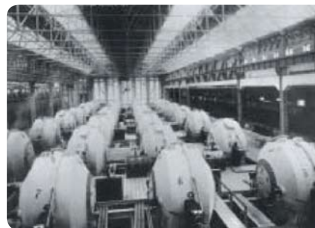
Wydział produkcji azotanu przy użyciu procesu Birkelanda w zasilanej energią wodną fabryce w Rjukan w Norwegii w 1912 r. oraz otwarty jeden z elektromagnetycznych reaktorów.
