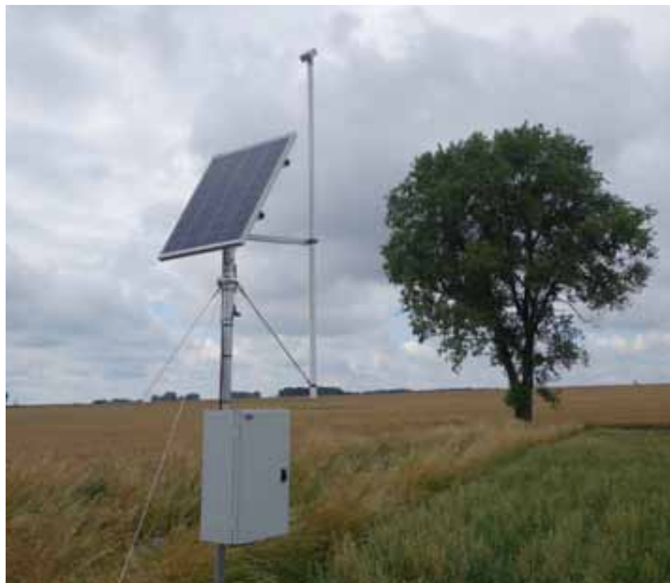
Fot. 1. Stacja bazowa systemu monitoringu wilgotności gleby oraz parametrów ładu w RZD Kępa-Osiny
