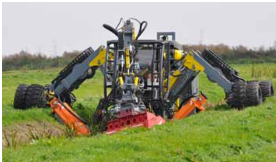
Zdj. 2 Wieloczynnościowy kombajn do renowacji rowów melioracyjnych – prototyp powstały w ramach projektu WND-POIG.01-03-01-00-165/09
